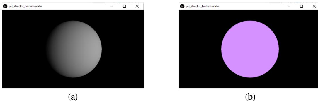
**Figura 9.1:** A la izquierda, Esfera iluminada con una luz direccional. A la derecha esfera coloreada con el *shader* del listado 9.2).
